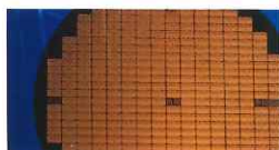
半導体チップの鏡面加工
